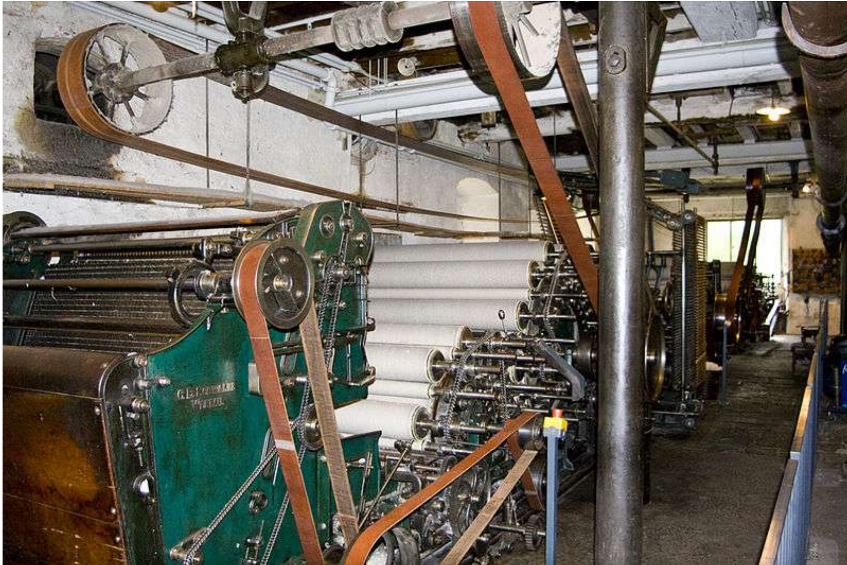
Dreikrempelsatz (Kardiermaschine) in der Tuchfabrik Müller, Euskirchen-Kuchenheim, Wikicommons - Gemeinfrei
